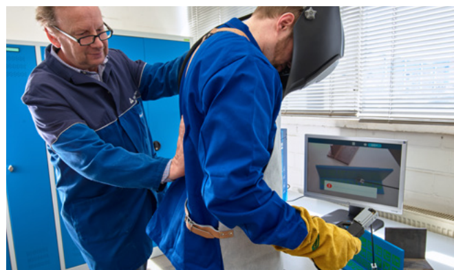
Übungseinheit zur Ergonomie: Während der Teilnehmer seine Schweißnaht zieht, konzentriert sich der Ausbilder ohne hinderliche Schutzausrüstung auf die Körperhaltung. Auch erfahrene Schweißer profitieren, wenn eingespielte Fehlhaltungen identifiziert werden.
